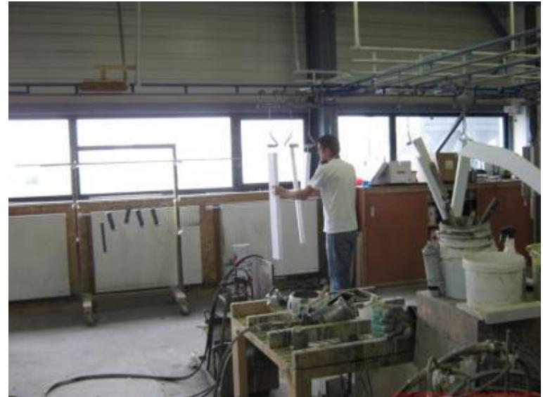
L'atelier dispose d'une aspiration centralisée avec targettes (registres) automatiques et de groupes haute dépression pour l'outillage électroportatif
