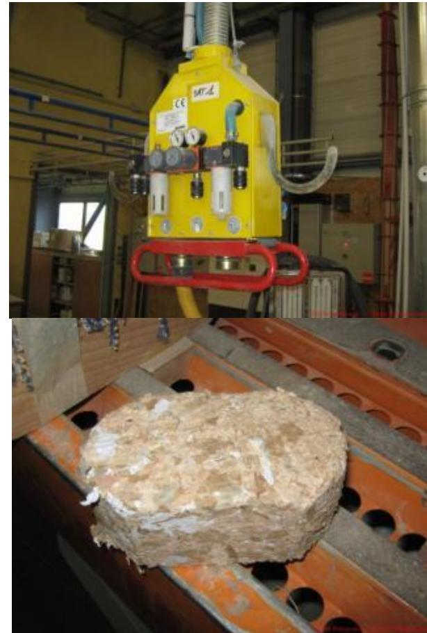
L'atelier dispose d'un système de compactage des poussières et déchets papier en briques utilisées pour le chauffage (production équivalente à 23000l de fioul/an)
